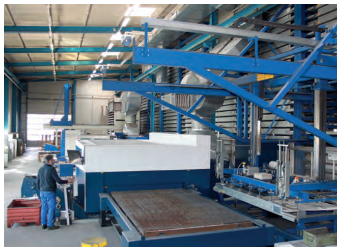
Auf der anderen Seite des automatischen Lagersystems sind die beiden Laserschneidzentren TruLaser 5040 beziehungsweise TruLaser 5040 fiber angedockt; im Vordergrund ist das Beladehandling für den Wechseltisch des Laserschneidzentrums TruLaser 5040 fiber zu sehen.
