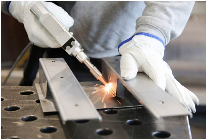
Die geringe Wärme- einbringung ge- währleistet weniger Verzug und Anlauf- farben am Bauteil.
